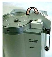
オートショット・サンプラーを用いることにより、固体試料の自動分析が可能です。左図は、タンデム  $\mu$ -リアクターにオートショット・サンプラーを取り付けた場合の装置外観です(外カバーを外した状態)。
