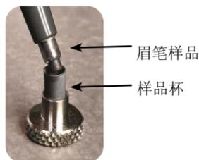
样品可以直接放到样品杯中，进样前不需要任何前处理。
