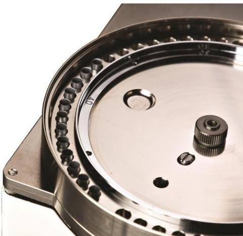
可连续处理多达 48 个样品。当您需要对单一样品进行重复进样时，自动进样器是很好的选择。每个样品可使用多种分析模式中的任意一种组合。分析结果更加可靠，减少了操作误差，重现性更加有保证。
